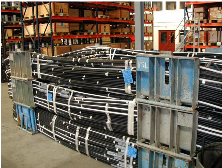
Auf Zwingen aufgewickelte Anker im Werk
