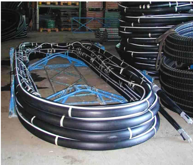
Auf Zwingen aufgewickelte Anker im Werk
