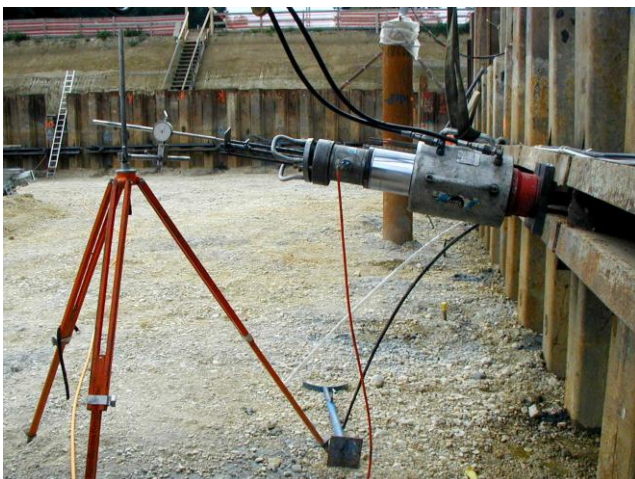
Spannvorgang mit Dehnmessung
