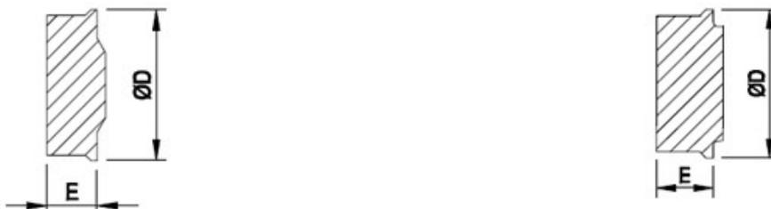
Figure 10 Section transversale d'une tête d'ancrage type CS
