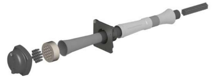
Alternativement, VSL peut également fournir une solution avec une enveloppe unique dans la zone d'ancrage. Pour cette configuration, la gaine doit dépasser de la face en béton pour permettre un raccordement étanche à la gaine PE.
