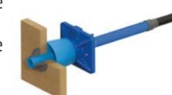
Les monotorons avec adhérence ou sans adhérence reposent sur des supports. La distance entre les supports ne doit pas dépasser 1 m pour les grands rayons de courbure (~10 m) et 0,5 m pour les petits rayons de courbure. Les gaines ou monotorons doivent être fixés aux supports ou aux armatures au moyen d'un fil de ligature.
