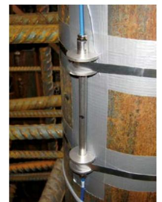
Surveillance de la précontrainte intégrée : capteurs répartis le long d'un câble précontraint de 12MN (Technologie Fibre Bragg)
