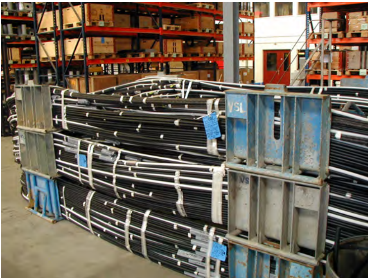
Tirants enroulés dans des corbeilles à l'usine
