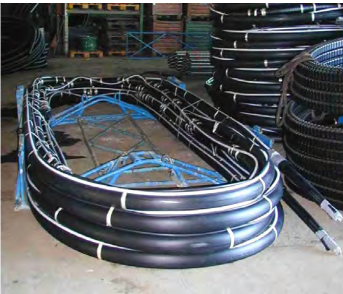
Tirants enroulés dans une corbeille à l'usine
