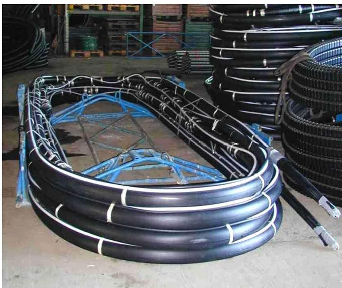
Auf Zwingen aufgewickelte Anker im Werk
